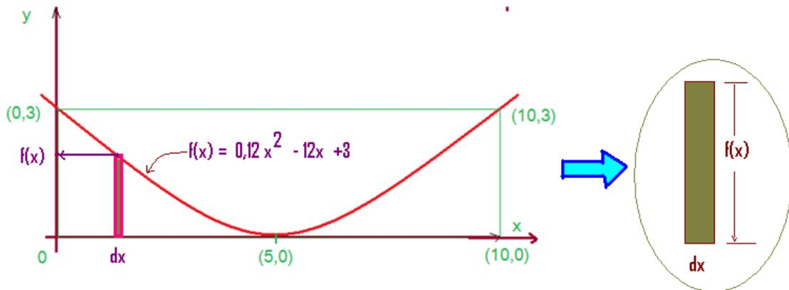
Un diferencial “dx” de la función  $f(x)$ ,. Se obtiene entonces infinitésimos rectángulos, cuya dimensión de la base mide dx y cuya altura es prácticamente  $f(x)=0,12x^2 - 1,2x + 3$  .
